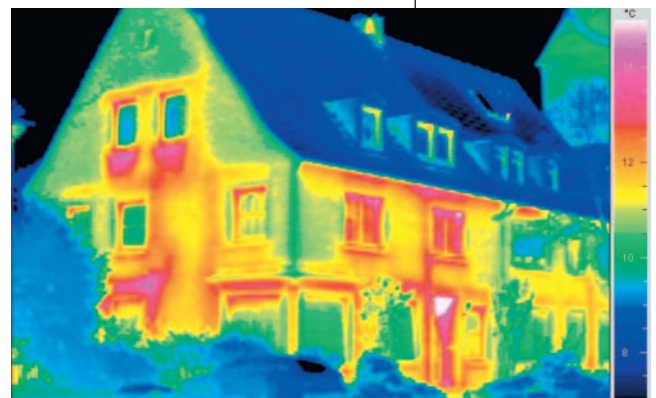
Bild 2: Wärmeverlust eines schlecht isolierten Wohngebäudes (Quelle: Verband Privater Bauherren e. V./ Bundesverband Deutscher Baustoff-Fachhandel e. V.)
